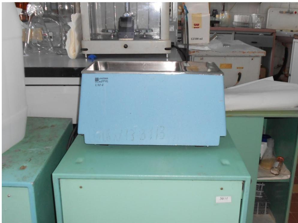
Рисунок 6 – Ультразвуковая ванна UM-4 фирмы "Unitra" (емкость ванны 4 дм<sup>3</sup>, частота 25 кГц)
